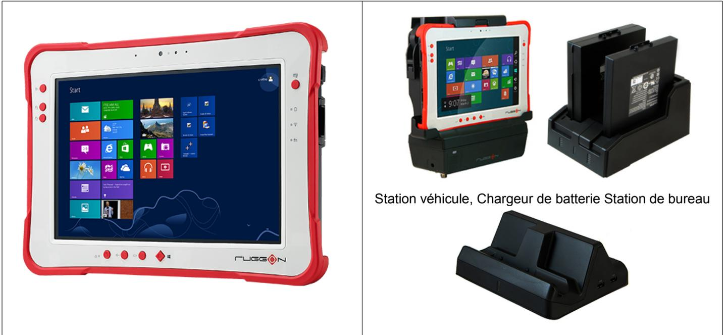
**La Tablette GR10** est une tablette tactile durcie (\*), multimédia, fonctionnant sous windows 7 et 10 64 Bits. Elle est robuste avec une conception conçue pour satisfaire les normes MIL-STD810G (hautes et basses températures, chocs, vibrations, chutes de 1,5m), résistante à l'eau et la poussière IP65, sans ventilateur, lisible au soleil.
